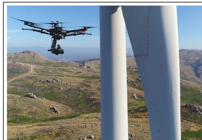
独自のSLAM搭載のシステムを取り付け、ブレード点検を行うドローン
