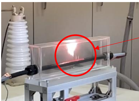
図9 人工地絡試験(微地絡)の様子(左: 気中、右: 水中)
