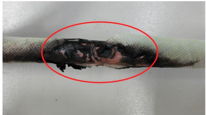
図7 人工地絡試験ケーブルと現場のケーブルとの外観比較
