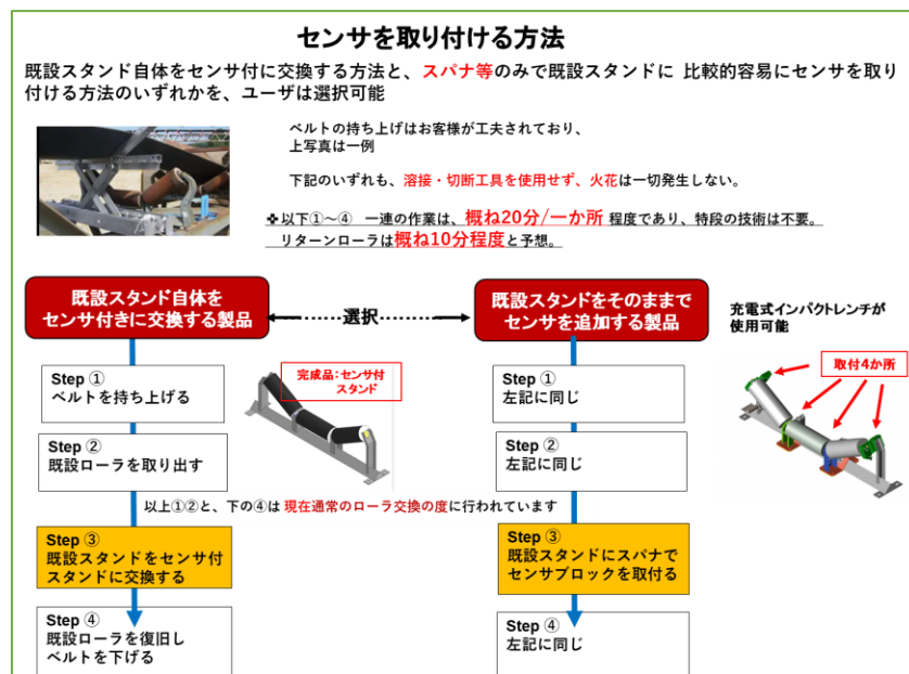
図6 トルクセンサの取付方法
