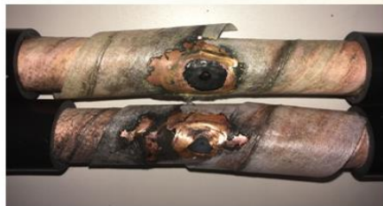
図7 人工地絡試験ケーブルと現場のケーブルとの外観比較
