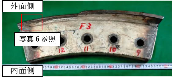
写真1b 破面外観および組織・SEM 観察位置 (部位 No. 13)
