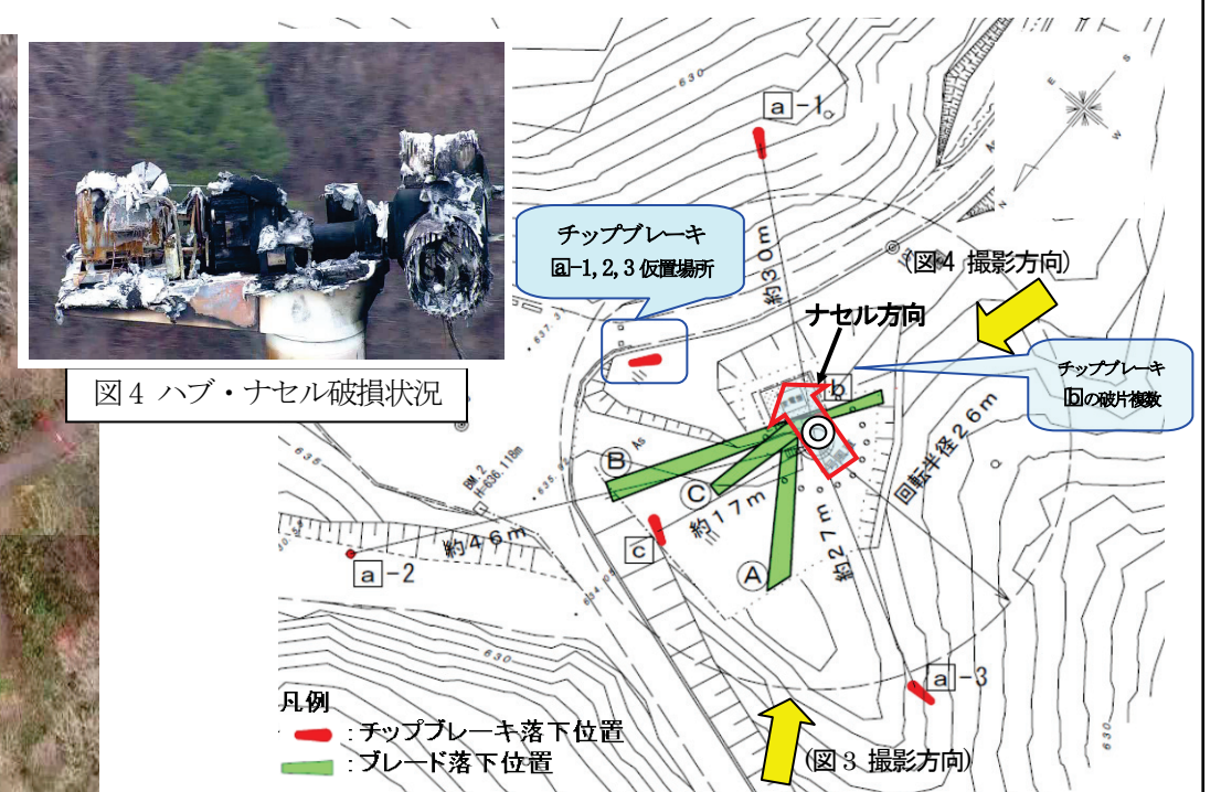
図5 ブレード落下状況
