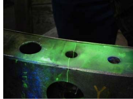
(工場持込後の磁粉探傷検査)
