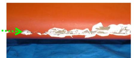
(※2) 塗装は剥離しているが, 接着面の全てが剥がれてはならず, 開口していない状態
