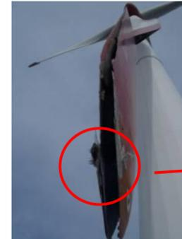
写真1 チップブレーキ裂け目状況
