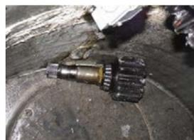
写真1 脱落したピニオンギア
