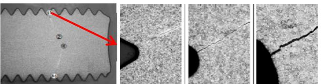
写真9 断面ミクロ観察(ネジ山底部)
