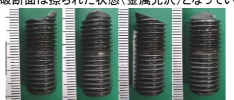
写真5 破断ボルト外観
