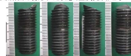
写真5 破断ボルト外観
