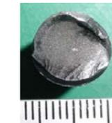
写真6 破断面外観
