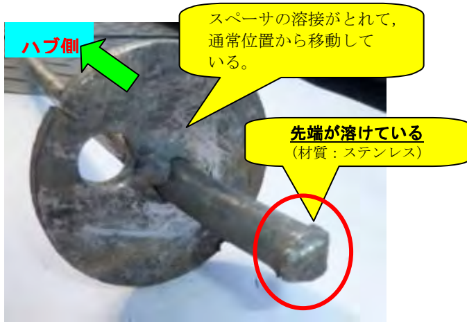
写真8 ダウンコンダクタ（ロッド）
