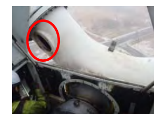
ハブ翼根部点検口（蓋は飛散）
