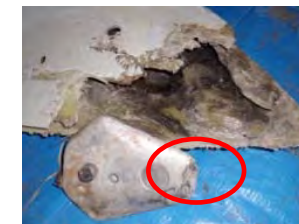
アンカーブロック（先端部溶損）
