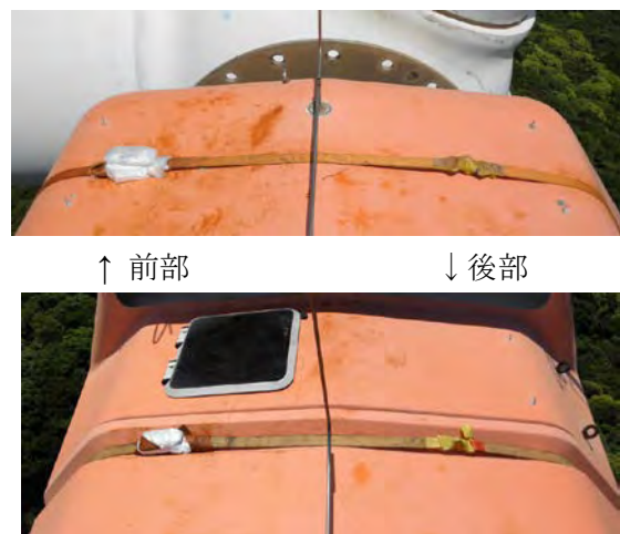
ラッシングベルト固定状況
