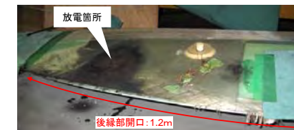
図6 新型J40a、ブレード内部、湿潤,600C放電後
