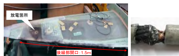
図5 新型JB50、ブレード内部、乾燥,600C放電後
