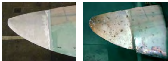
図3 新型J40aレセプタ放電試験前後の外観
