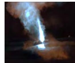
放電13ms後(後縁部開口) 図4 新型J40aブレード内部、湿潤,600C放電時の高速カメラ画像
