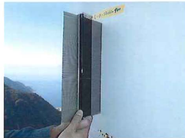
No.1 Gポジション 測定 1mmの凹みを確認 許容不整値内
