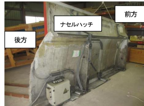
写真5 落下したナセルカバー(内側)
