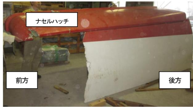
写真4 落下したナセルカバー(外側)
