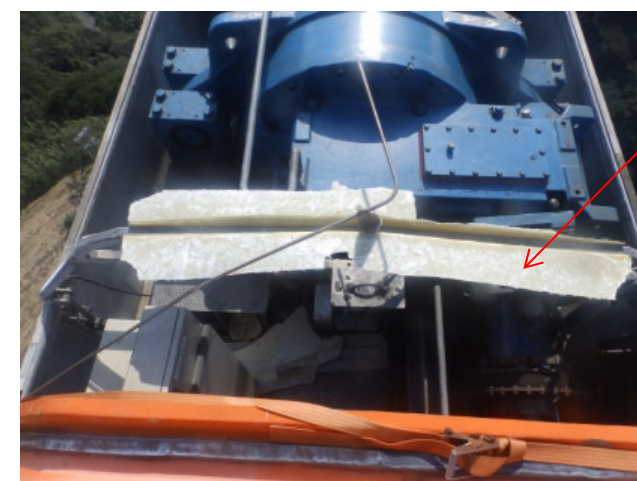
図4 ハット構造接合の剥離例（写真は根占4号脱落時のもの）
