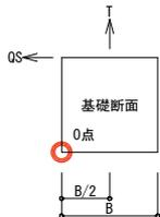
$$\text{浮上りによる転倒モーメント } M_u = T \times B / 2$$
