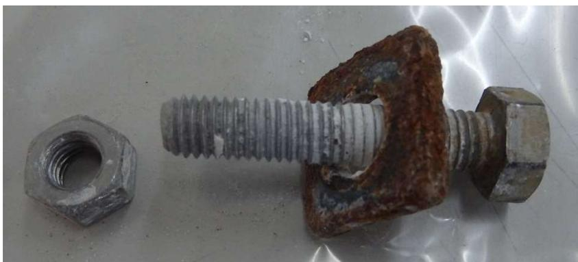
図 7-3 ステンレスのボルト、ナットに亜鉛めっきされた鉄の座金を使用した場合の腐食事例
