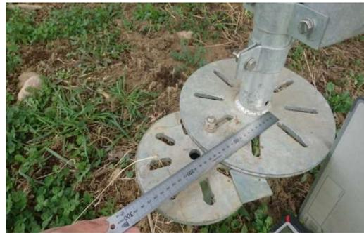
図 6-3 杭頭部のズレが大きすぎる事例
