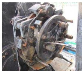
図3.2 機械ブレーキシステム
