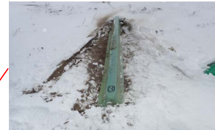
⑤ ブレード内部部材 (長さ2m)
