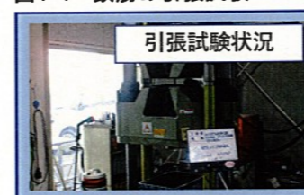
図4-4 鉄筋の引張試験
