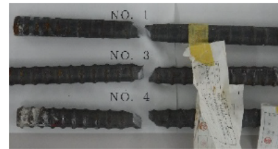
図4-13 試験による鉄筋の破断面
