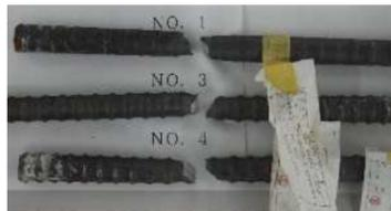
図4-13 試験による鉄筋の破断面
