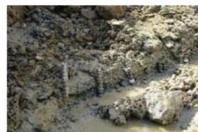
図1-5 鉄筋破断
