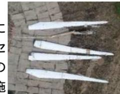
図4-1 破壊ブレードの復元
