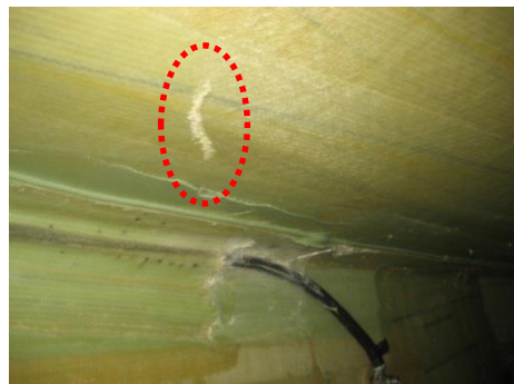
①ブレード内部クラック
