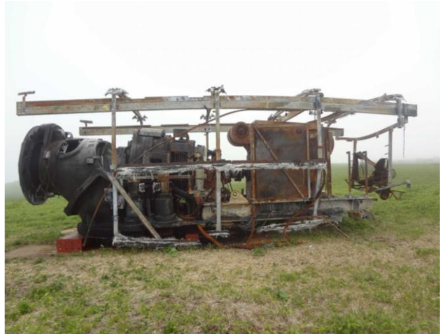
図2.3(5) ナセル焼損状況
