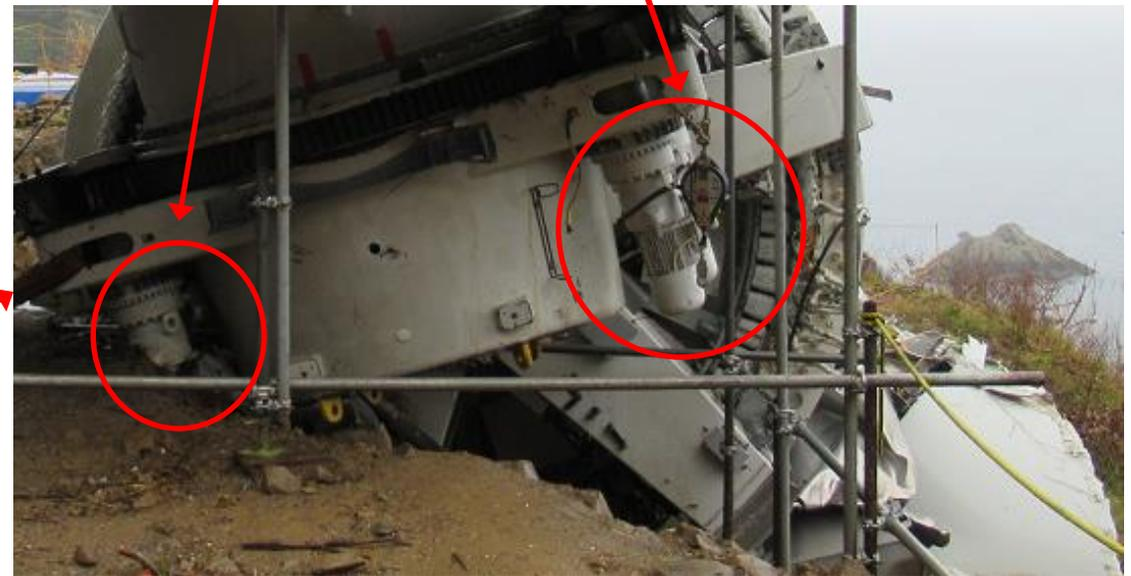
ヨーマータは風車に 6 台設置され、各 3 台（# 1 ~ # 3 および # 4 ~ # 6）がナセルの左右位置に設置される
