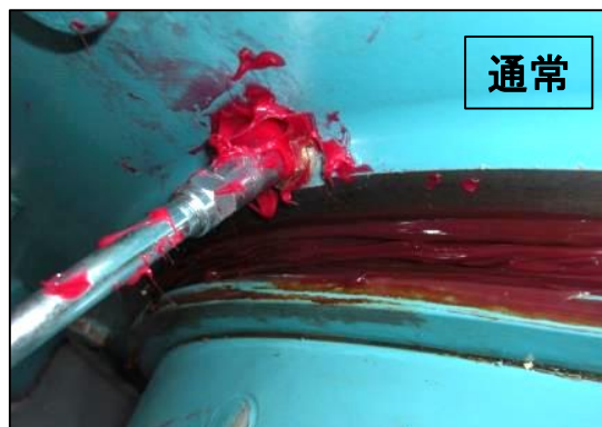
別添 8.3 1号機グリス注入時の状態 (モービルSHC460WT)
