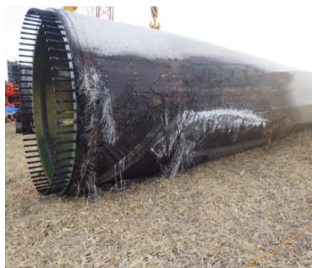
別添 2.2 ブレードの状況
