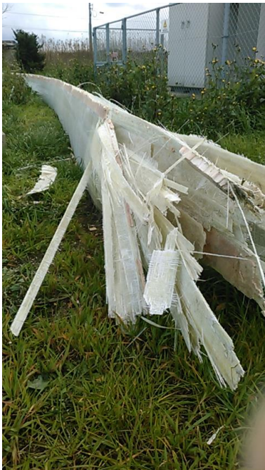
落下したブレードの一部
