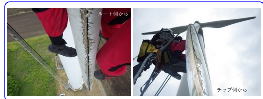
先端付近開口 (2019.5.31点検時 31m~Tip間 約2.5m範囲)
