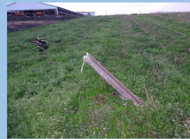
⑱ スパー (TE) 29-31m ⑲ スパー (TE) 先端 ⑳ スパー (TE) 27-28m (バランスウェイト)
