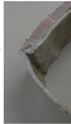
切断フランジ部位 カットモデル (破損ブレードより切り出し)
