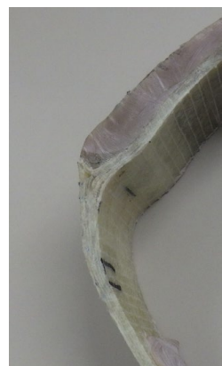
正常部位カットモデル (破損ブレードより切り出し)
