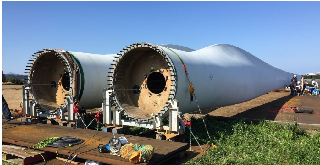
図4-3 残存ブレード内部検査・UT検査実施状況（写真）
