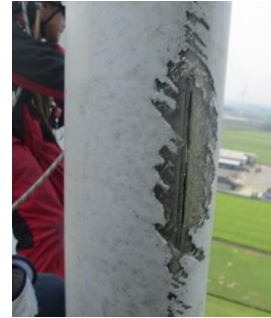
【経年変化①】 エロージョンによる オーバーラミネート損傷 (2015年東伯4号#1ブレード)
