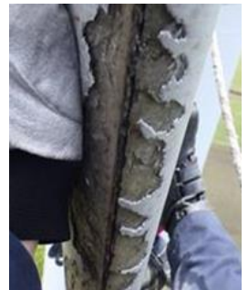
【経年変化②】 オーバーラミネート損傷進展 ・切断フランジ部開口 (2017年東伯4号#1ブレード)
