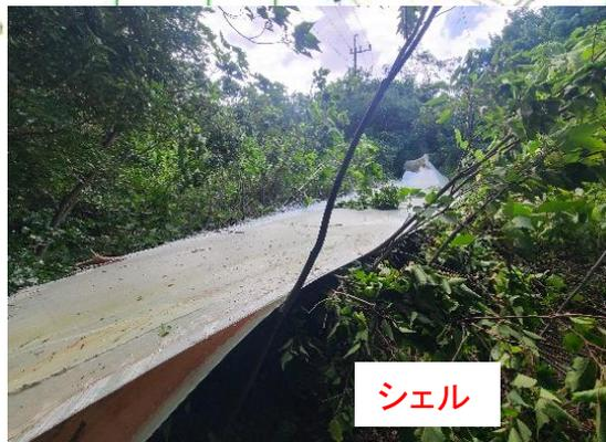
8号機のブレード飛散物は、風車の北から北北西方向約30° 前後の範囲で確認された
