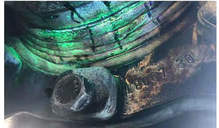
◆ 非破壊検査 --- 浸透探傷試験
