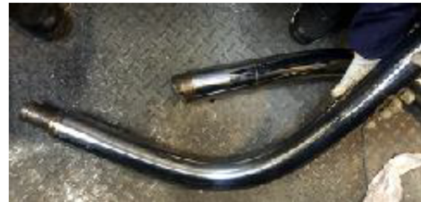
台風時の負荷により曲がった ピッチシリンダシャフト
