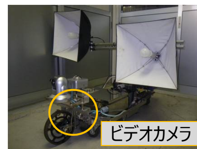
水圧鉄管内面点検装置 点検台車
