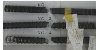
図4-13 試験による鉄筋の破断面
