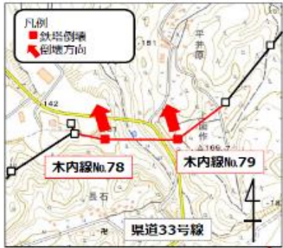
鉄塔の倒壊方向
