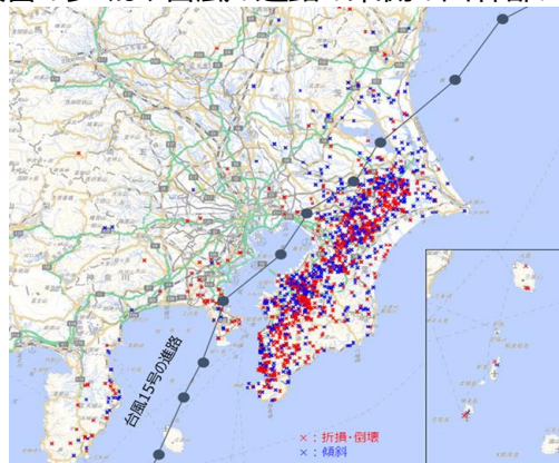
＜電柱の被害発生状況分布図＞ (被害の多くは、台風の進路の東側の山林部に集中)
