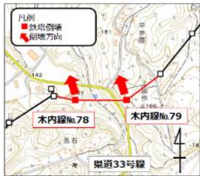
鉄塔の倒壊方向
