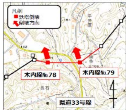
鉄塔の倒壊方向
