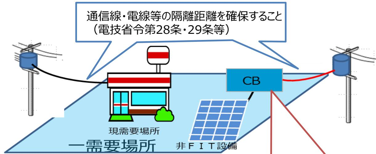
一需要場所の中で、低圧・高圧の引込みが混合して行われる可能性がある。
