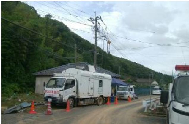
高圧発電機車による応急送電の様子（記載箇所とは別現場）
