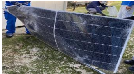
民家の庭に散乱したモジュール
