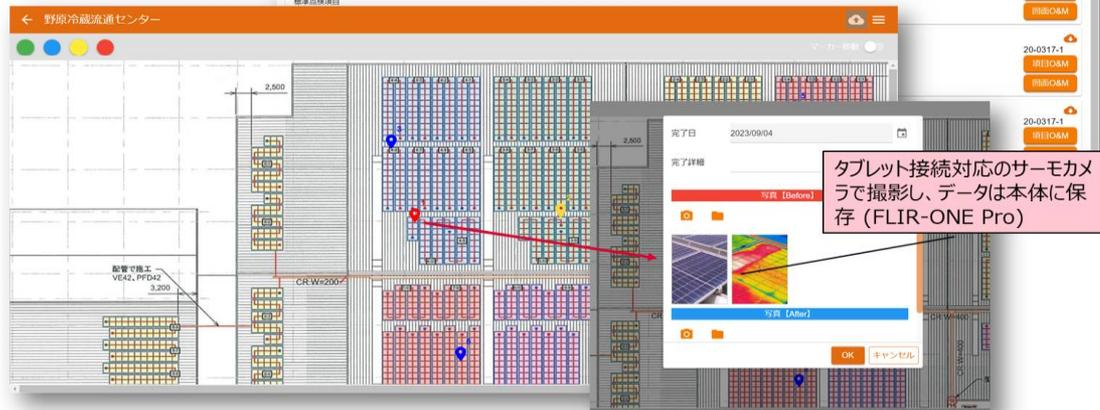
タブレット接続対応のサーモカメラで撮影し、データは本体に保存 (FLIR-ONE Pro)
