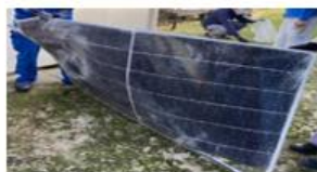
屋根上に飛散したモジュール 民家の庭に散乱したモジュール
