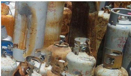
中には凹み、潰れた容器もある
