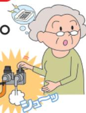
近年、二口ガス栓でガス機器に接続されていない方の元栓を開けてしまう「誤開放」事故が増えています。誤開放はガス漏れや火災につながるおそれがあり、大変危険です。
