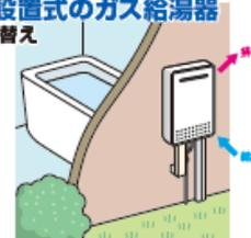
煙突の外れなどで室内へ排気ガスが漏れる心配がなくなり、屋外の新鮮な空気を取り入れ、排気も屋外に排出しますので、より安心してガスをお使いいただけます。
