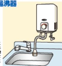
最近のガス小型湯沸器には、不完全燃焼を起こすと、ガスを自動的に止める不完全燃焼防止装置が付いています。
