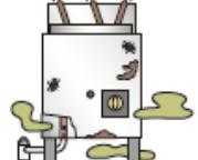
ガス機器が腐食劣化して穴が空いていると、その部分からガスが漏えいします。漏えいしたガスに近くの火が引火して爆発します。厨房設備の周囲に可燃物をみだりに放置すると、延焼のおそれがあります。
