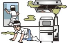
汚れや劣化によってガスバーナーの給気口や炎孔が詰まると、不完全燃焼が起こりCOが発生します。給排気設備が正常に作動しないと、換気ができなくなるだけでなく、燃焼に必要な空気が不足して不完全燃焼を助長します。
