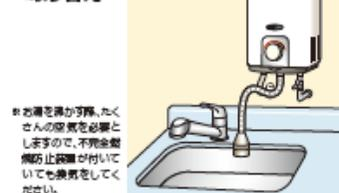
最近のガス小型湯沸器には、不完全燃焼を起こすと、ガスを自動的に止める不完全燃焼防止装置が付いています。
