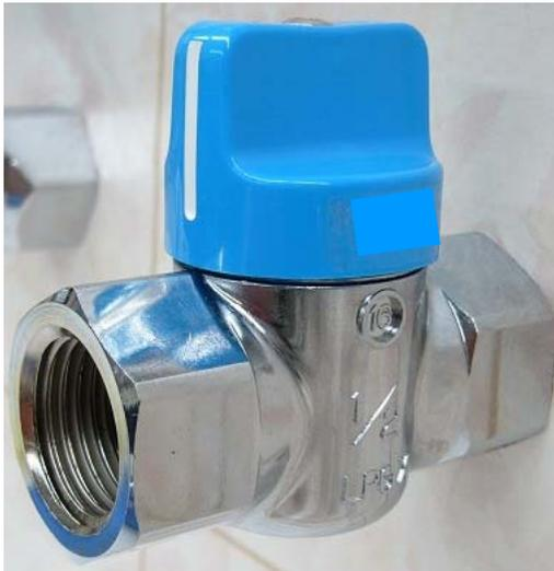
「可とう管ガス栓」は、閉状態を容易に変えることができないよう、つまみに押し回し機構（ロック機構）があり、末端ガス栓として安全に使用できます。ガス栓を開ける際は、つまみを押し回す操作が必要です。
