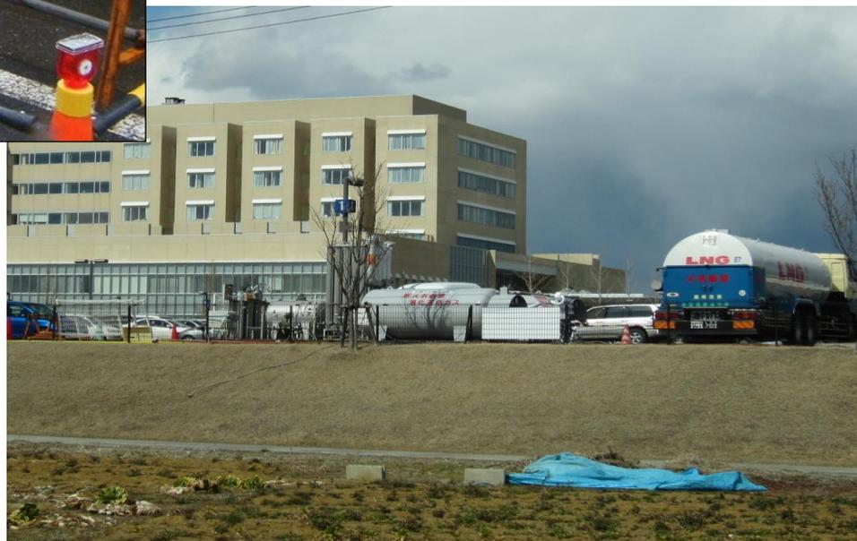
LNGローリー+ 移動式ガス発生設備(50m<sup>3</sup>/h)による臨時供給
