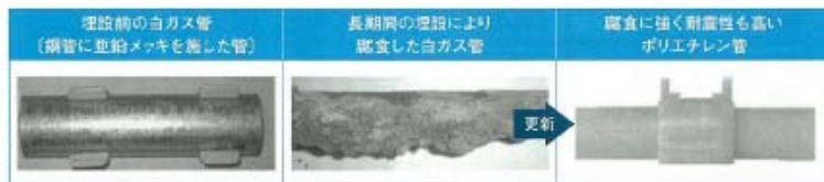
写真 埋設ガス管の劣化とポリエチレンガス管への更新
